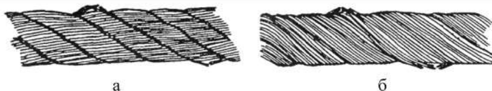
Рис. 2. Сочетание обрывов проволок с их износом: а – в канате крестовой свивки; б – в канате односторонней свивки
